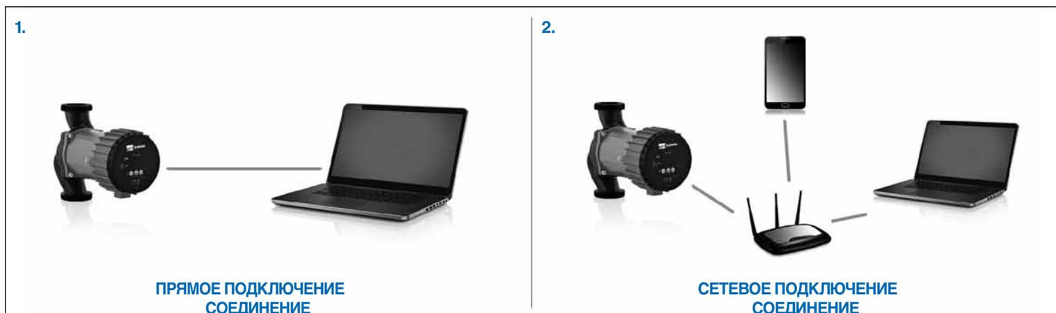
Подключение через Ethernet позволяет получить доступ к циркуляционному насосу через любой интернет-браузер (Chrome, Internet Explorer, Firefox и т. п.) путем ввода IP-адреса насоса, который указан в руководстве по эксплуатации. После установления связи с ПК через различные страницы дисплея можно не только просматривать мгновенные параметры работы насоса, но и полностью запрограммировать его работу, цифровые входы, реле и т.д.
